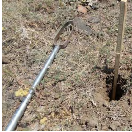
Նկար 5. Հողի նմուշառում ձեռքի հատուկ հորատիչ գործիքով
